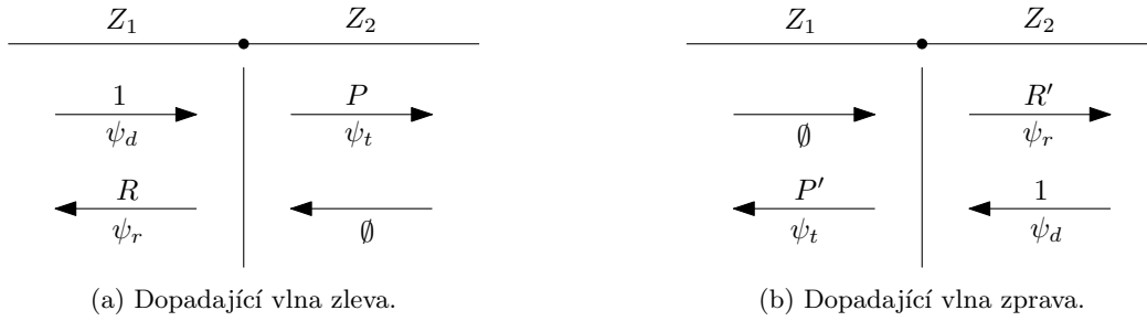
Obrázek 4.8: Napojení dvou strun o impedancích Z_1 a Z_2 . Studujeme odrazy pro vlnu dopadající zleva i zprava.
